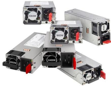
雅特生科技全新推出的 [CSU 系列](#) 提供由 550W 至 2400W 等不同功率以供选择, 不同型号各有不同的额定功率, 让生产计算系统、网络配件和存储系统等基础结构设备的厂商可以因应不同需要, 例如, 针对不同设备如企业级信息系统、云和超大规模计算等应用的不同要求, 灵活选择不同的功率。这系列产品的所有型号无论外型设计和尺寸大小都完全相同, 而且都提供相同的功能, 确保同一系统设计可以支持未来一代的先进技术。服务器厂商可以利用这系列电源生产各式各样的服务器, 其中包括低成本的入门级系统以至耗电量较大但体积则极为小巧的高性能服务器。CSU 系列电源装设于一个 1U 高的小型密封机壳内, 大小仅为 2.89 x 7.28 英寸 (73.5 x 185.0 mm), 体积可以缩至如此小巧, 完全是因为采用了最新的交换式电源转换技术和高密度的元器件封装所致。
