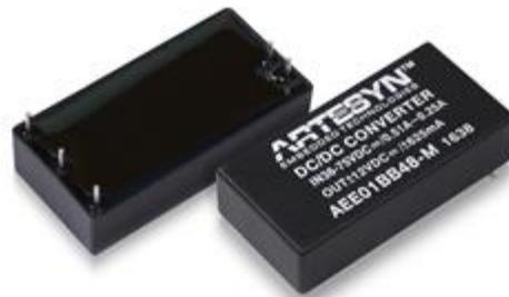
医療機器に欠かせない補強的絶縁システムは、300Vac の動作電圧と 4200Vac RMS を定格とします。この新しい DC-DC モジュールは、UL / CSA / EN / IEC 60601-1 医療安全基準第 3 版に適合しており、2 倍の患者保護方法 (MOPP) の評価を受けています。この高信頼性ファミリーの MTBF は、100 万時間以上と計算されています。
