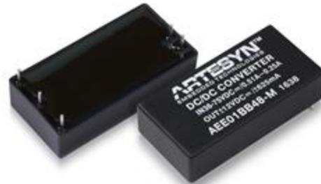
加強絕緣系統是醫療設備必要的關鍵組件，其額定工作電壓為 300V(交流)，輸入輸出隔離電壓則為 4200Vrms(交流)。這些全新的直流/直流電源模組符合 UL/CSA/EN/IEC 60601-1 醫療設備安規標準(第 3 版)的規定，可為患者提供雙重絕緣保護(2X MOPP)。這系列直流/直流電源模組高度穩定可靠，其平均無故障時間(MTBF)的估算值高達 1,000,000 小時以上。
