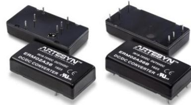
這系列 ERM 電源轉換器模組採用 1 英寸 x 2 英寸(25.4mm x 50.8mm)的密封式 DIP 封裝，而且即使不再另外添加三防漆塗層，也不會受戶外天氣變化的影響而損壞。這系列直流/直流電源轉換器模組可在攝氏 -40 至 85 度如此寬廣的溫度範圍內正常作業，而且可以降額輸出，另外還有散熱片可供選用，以便在高溫作業時可以加強散熱和提高效能。
