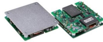
ADH700 시리즈 공칭 28 V 모델은 최대 28.A 출력 전류를 제공하며 14 V ~ 33 V 의 넓은 트림 범위를 지원한다. ADH700 시리즈는 산업 표준 하프 브릭 포맷(2.4 x 2.3 인치 또는 61.0 x 57.9 mm)으로 높이는 0.5 인치 또는 12.7 mm 이다. DC-DC 컨버터 시리즈는 95% 이상의 표준 효율을 제공하며 36 ~ 65 V 의 넓은 입력 범위를 지원한다. ADH700 시리즈 모듈은 또한 알루미늄 베이스플레이트 구조로 열 효율이 뛰어나다. 28 V 모델은 - 40 ~ 85°C 의 대기 온도에서 작동할 수 있으며 최대 100°C 의 베이스플레이트 온도에서도 별도의 냉각 조치 없이 최대 성능을 발휘한다. 변환 기술은 280 kHz 고정 주파수 스위칭을 채택하여 외부 EMI 필터링 요구 사항을 최소화하는 데 도움을 준다.
