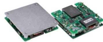
ADH700 系列的第一款產品可提供 28V 的額定輸出以及 28A 的輸出電流，輸出邊限微調非常寬廣(14V 至 33V)。這系列產品採用 1/2 磚電源模組的業界標準封裝，大小僅 2.4 x 2.3 英寸(61.0mm x 57.9mm)，高度只有 0.5 英寸(12.7mm)，電源轉換效率則高達 95% 以上(典型值)，而且輸入電壓範圍極寬(36V 至 65V)。由於這系列直流/直流電流轉換器採用鋁基板的设计，因此所有產品的散熱能力都極為卓越。換言之，即使在自然空氣對流散熱下，這款 28V 的產品仍然可在攝氏 -40 度至 85 度之間的溫度環境下正常作業，甚至基板溫度高達攝氏 100 度，也可繼續以全功率作業。此外，這款電源轉換器採用以 280kHz 為固定開關頻率的電源轉換技術，因此可將所需的外置電磁干擾濾波器減至最少。
