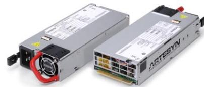
這款 DS2000SPE 電源產品配備主動式功率因數校正功能，因此以 20% 負載開始作業時，功率因數便高達 0.9，確保輸入諧波電流失真可減至最少。
