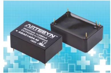
ASA6W-M 系列产品配备一组 4000V(交流)的强化绝缘电阻，其绝缘阻抗为 10Gohm，符合操作者防护方法(MOOP)的双重绝缘保护(2X MOOP)规定。此外，这系列产品也符合 UL/cUL/EN/IEC 60601-1 医疗设备安全标准(第 3 版)的规定，而且产品本身高度稳定可靠，其平均无故障时间(MTBF)高达 1,000,000 小时。
