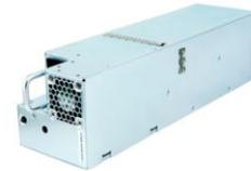
這款電源供應器的效率高達 94%，用戶可將多達 6 個電源供應器平行連接一起，以便執行主動式負載均流功能，並確保負載供電可達滿載的 35% 至 100%。這款電源供應器配備主動式功率因數校正(PFC)和浪湧電流控制功能，以及符合適用於 A 級(Class A) 工業用產品的電磁干擾規定，而且還可透過業界標準的 PMBus 介面執行監控功能。
