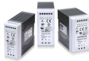
ADNB 系列電源供應器適用於 88V 至 264V 的交流輸入電壓，而且獲全球多個相關機構頒發產品安全認證，因此這系列電源產品幾乎可以在世界任何地方使用。此外，這系列新產品也適用於 124V 至 370V 的直流輸入電壓，同時也可提供準確的穩壓輸出，並有 12V、15V、24V 和 48V 等不同的直流輸出電壓可供選擇，其能源效率高達 84% 至 88%(典型值)，而且可以在高達攝氏 70 度的溫度下作業。這系列電源供應器採用作業溫度高達攝氏 105 度的長壽電解電容，因此產品壽命也較長，另外更配備一個固定用的安裝夾片，確保安裝時無需工具也可輕易將電源固定在軌道上，因此最適合工業製品採用。
