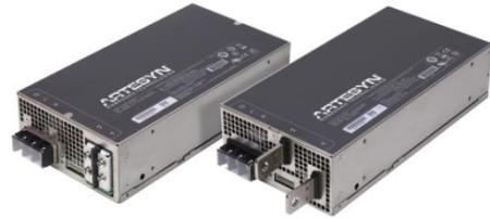
这一全新的电源系列有 12V、15V、24V、36V 或 48V 等多种额定的单路输出可供选择, 而且输出电压可在额定值的  $\pm 10\%$  范围内上下调整。此外, 这系列产品还有 5V 的待机输出可供选择, 因此即使设备名义上已关闭, 系统仍可支持 OEM 厂商预设的待机功能。这系列全新的 LCM1000 产品另外还集成了先进的数字控制环路, 确保无论负载大小, 系统也可充分发挥其效率, 甚至满载运行时其转换效率也可高达 91% 以上, 功率因数达 0.99 (典型值), 而功率密度则达 7.7W/cu in。采用数字控制技术的另一优点是工程师能以极具成本效益的方法迅速修改电路设计, 以确保实际应用时能满足个别客户的特殊要求。雅特生科技一直不断投资于改善 LCM 系列的工艺技术, 其中包括提高生产自动化的程度, 以便缩短产品的交货时间以及降低无存货产品的最低订购量。
