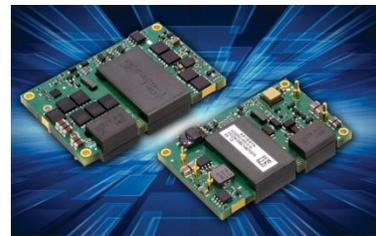
この **ADQ600** シリーズは入力電圧範囲が **40** から **60V** で、主としてコンピューティング及びサーバアプリケーションへの標準 **48 V** 供給、通信機器への高精度 **48 V** 供給を対象に設計されました。全負荷時で標準 **95.6%** という超効率、そして周囲温度 **-40°C** から **+85°C** まで動作可能なため、この製品は非絶縁型コンバータに電力供給する分散型電源アーキテクチャの絶縁型コンバータとして、理想的な選択肢です。オープンフレーム設計は、強制空冷又は伝導冷却用に最適化されており、熱特性がさらに向上したアルミニウム製ベースプレートのオプションもあります。また **175 kHz** 固定スイッチング周波数を採用した変換技術は、外部 **EMI** のフィルタリング要件を最小に抑えるのに役立っています。
