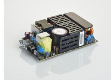
LPS360-M 시리즈는 Stand by 5 V 2A 및 팬 출력 12 V 1A 를 제공하며 단일 12, 15, 24 및 48 V 조절형 출력 모델로 구성된다. 90–264 Vac 또는 120-300 Vdc 입력 범위를 가진 LPS360-M 시리즈는 능동적 역률 교정(PFC 일반 값 0.99) 및 완전 부하 시 최대 93 퍼센트의 효율성을 자랑한다. 이 전력 공급장치의 표준 작동 온도 범위는 0 ~ 50 도(섭씨)이지만 정격을 낮추면 최대 70 도까지 작동할 수 있으며 저온 범위에서는 영하 40 도가 한계이다.
