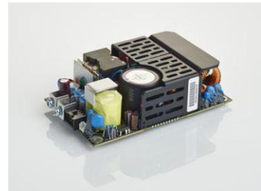
LPS360-M 系列有多個不同型號，分別提供多種不同的可調節單路輸出電壓，其中有 12V、15V、24V 和 48V 等輸出的型號可供選擇。此系列產品全部配備 5V 備用輸出電壓，可提供 2A 電流，另外又可提供 12V 輸出電壓和 1A 電流，以便驅動散熱扇。LPS360-M 系列適用於 90V 至 264V 的交流輸入電壓範圍或 120V 至 300V 的直流輸入電壓範圍，並配備主動式功率因數校正(PFC)功能，其功率因數校正典型值為 0.99，而且滿載輸出時效率可高達 93%。這系列電源的標準工作溫度範圍為 0 至 50 攝氏度，即使工作溫度高達 70 攝氏度，仍可透過降額輸出繼續作業，而且也可在-40 攝氏度的情況下啟動。
