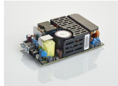
LPS360-M 系列有多个不同型号，分别提供多种不同的可调单路输出电压，其中有 12V、15V、24V 和 48V 输出的型号可供选择。此系列产品全部配备 5V 待机输出电压，可提供 2A 电流，另外又可提供 12V 输出电压和 1A 电流，以便驱动散热风扇。LPS360-M 系列适用于 90V 至 264V 的交流输入电压范围或 120V 至 300V 的直流输入电压范围，并配备主动式功率因数校正(PFC)功能，其功率校正因数典型值为 0.99，而且满载输出时效率可高达 93%。这系列电源的标准工作温度范围为 0 至 50 摄氏度，即使工作温度高达 70 摄氏度，仍可通过降额输出继续操作，而且也可在-40 摄氏度的情况下启动。
