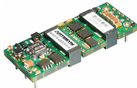
92 パーセント以上の効率と動作温度範囲 -40 から +85°C という優れた熱特性を持つこの AVO75 シリーズは電力供給に最高効率を要求するネットワーク機器メーカーとキャリアにとって理想的な選択です。一例として、このユニットは周囲温度 55°C における標準 200LFM の空冷で入力電圧 48V に対しフル使用可能な電力出力を提供することができます。
