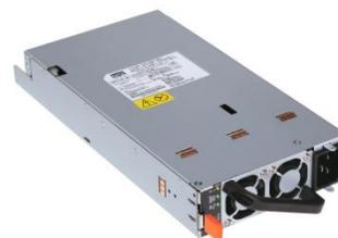
DS2500PE-3 電源は、ダウストリーム DC-DC コンバーターに供給するための 12VDC と 208A のメインペイロード出力および電力管理回路用の定格 2.7A の 3.3VDC のスタンバイ出力を生成します。サイズはわずか 11.56 x 5.47 インチ (293 x 139 mm)、ユニットの高さは 1.689 インチ (43 mm) で、Artesyn DS2500PE-3 は小型電源ながらも最大効率 94%を達成しています。
