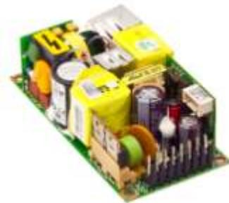
艾默生網絡能源這款 LPS109-M 電源的主輸出符合 IEEE 802.3at-2009 乙太網路供電標準的電氣隔離規定，而且已取得多個產品安全方面的認證，不但適用於資訊科技設備 (ITE) 以及各種非直接接觸病人和並非對病人健康起關鍵作用的醫療設備，而且也適用於許多不同的低功率電子設備。
