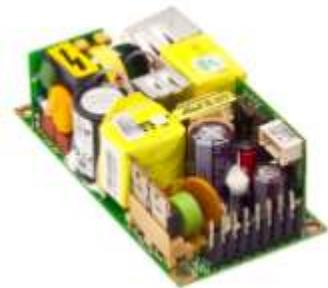
Emerson Network Power LPS109-M의 기본 출력은 IEEE 802.3at-2009 PoE 표준의 전기 절연 요건을 충족한다. 전원 공급 장치는 또한 정보 기술 장비(ITE) 안전 승인과 환자와의 접촉이 없고 환자에게 중요하지 않은 의료 안전 승인을 받은 제품으로, 다양한 저전력 애플리케이션에 사용하기 적합하다.
